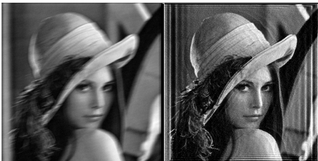
Obrázek 2.1: Vlevo snímek Leny rozmazán pohybovým rozmazáním o 20 pixelů pod úhlem 18^\circ . Vpravo rekonstrukce pomocí Richardson-Lucy algoritmu
