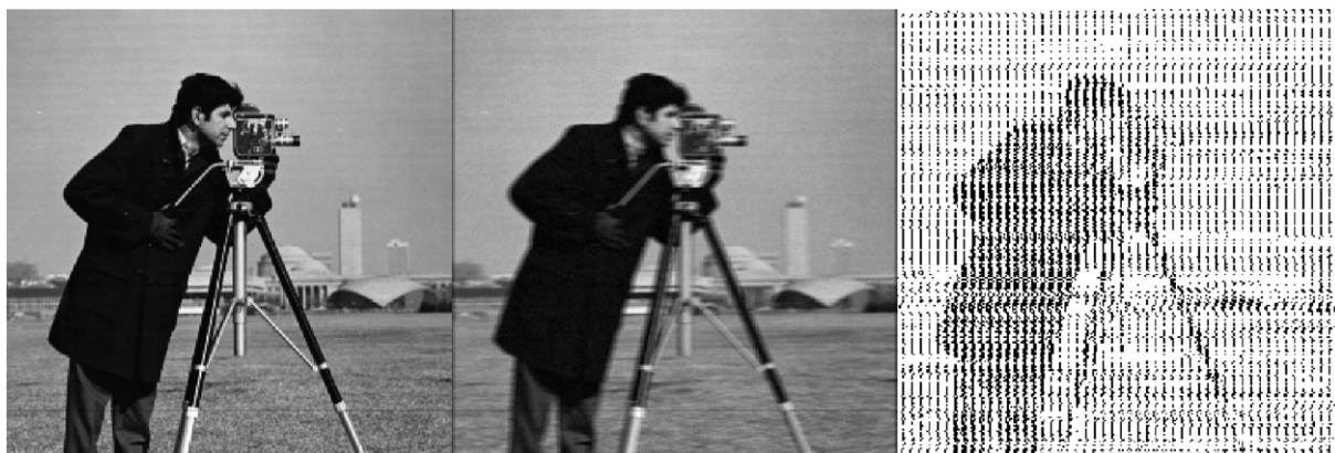
Obrázek 1.3: Vlevo výchozí obrázek kameramana, uprostřed po konvoluci s PSF P = (\frac{1}{5}, \frac{1}{5}, \frac{1}{5}, \frac{1}{5}, \frac{1}{5}) , vpravo po dekonvoluci metodou Fourierových koeficientů
