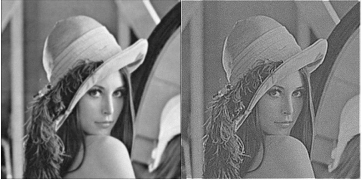
Obrázek 2.2: Ukázka dekonvoluce Landweberovou iterací, \lambda = 0, 1 , počet iterací 20
